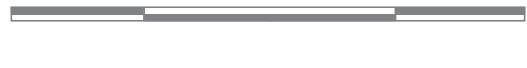
Tvåspårig med fyra skjutbara dörrblad Fri öppning = KYM / 2 - 325 mm KYM = Fri\ öppning \times 2 + 650
